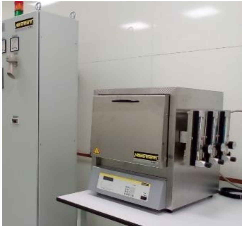
Fig 9. Cuptor tubular si cuptor calcinare pentru tratamente termice in atmosfera controlata.
