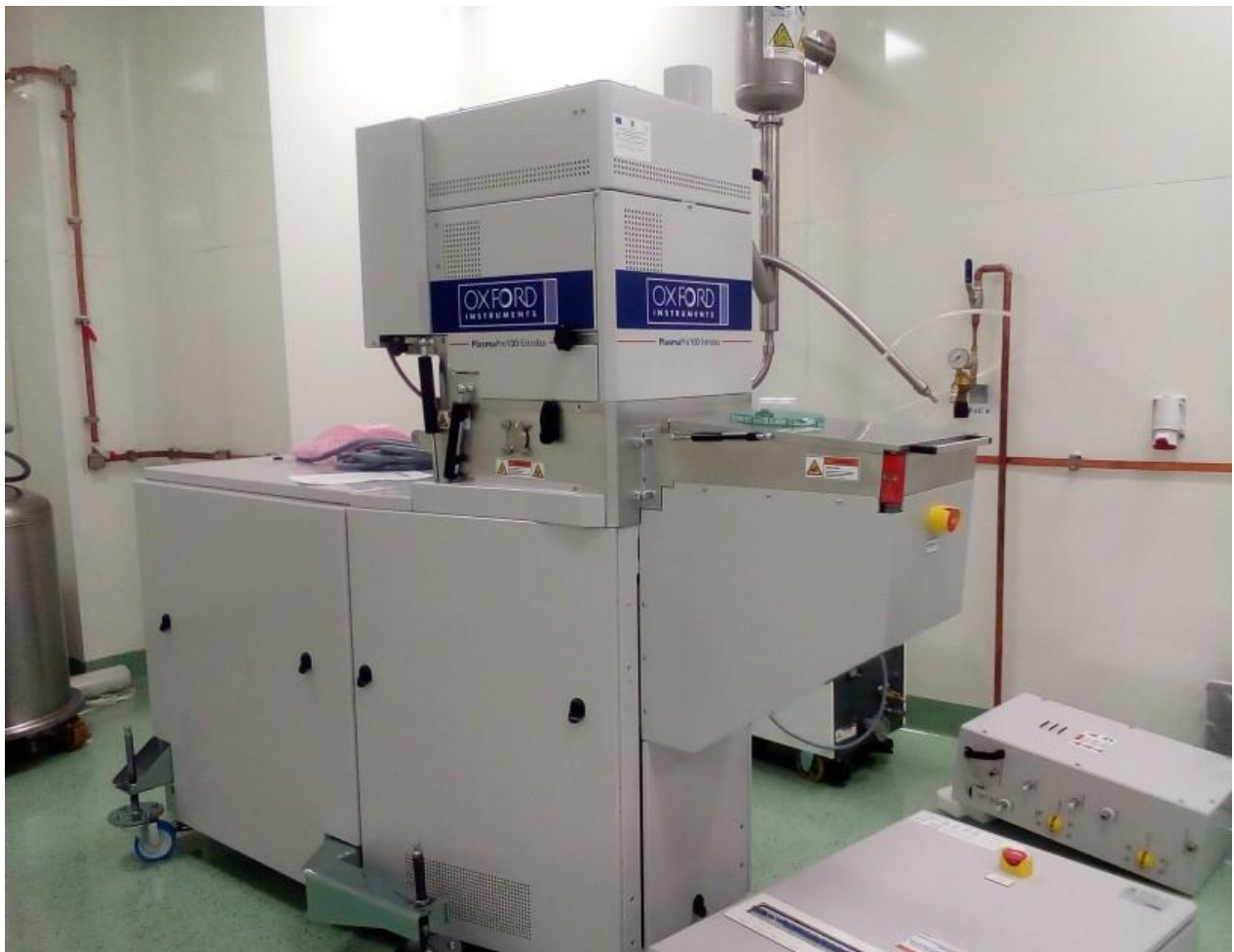
Fig. 3. Instalatia pentru corodare fizica si chimica cu plasma cuplata inductiv (RIE).
