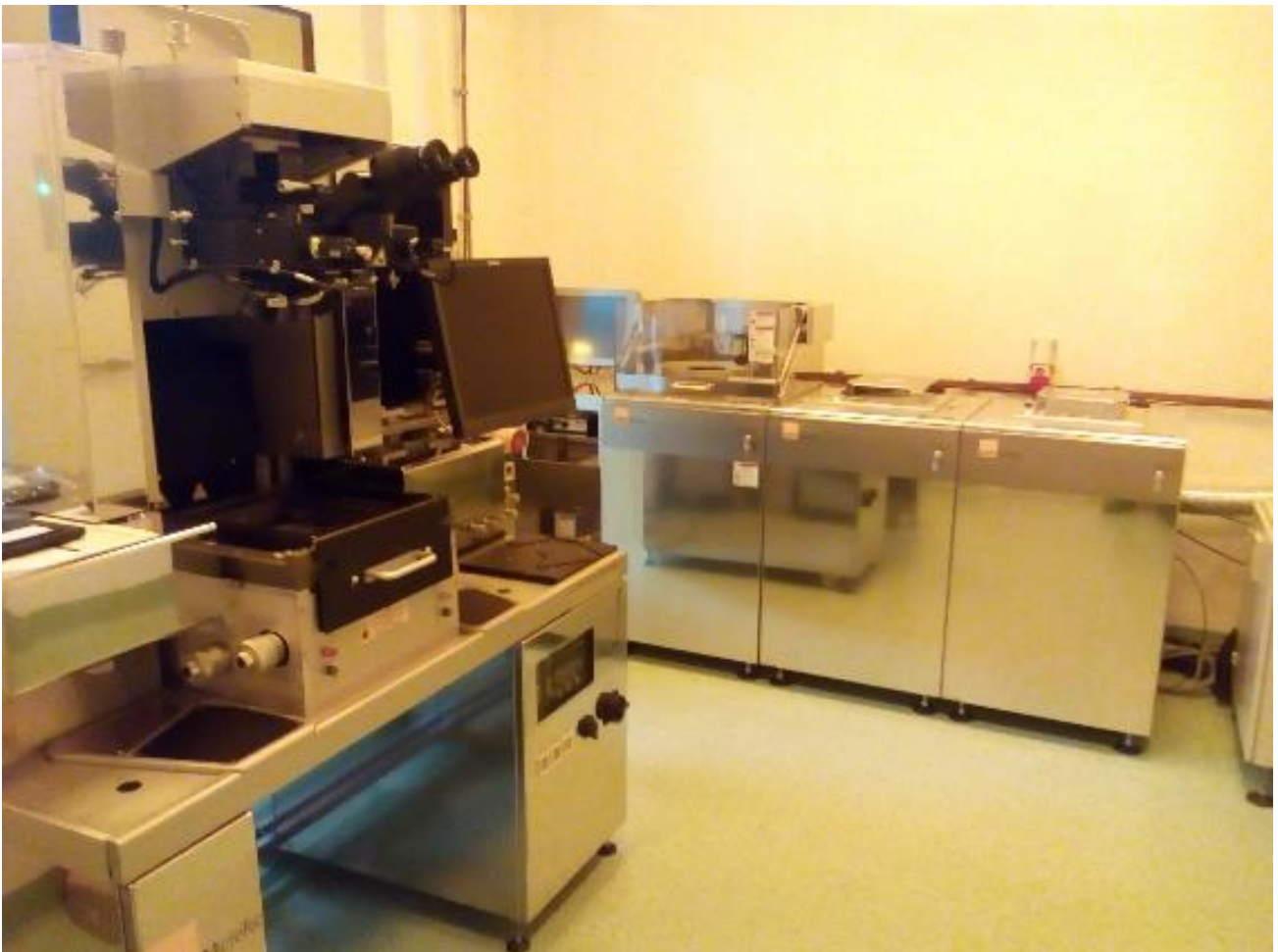
Fig. 5. Instalatie pentru litografie optica (mask-aligner, spin coater, hot plates).
